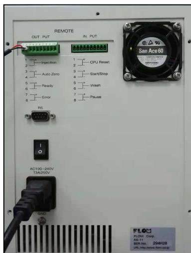
图 B-6 AS-11 后面板连接
